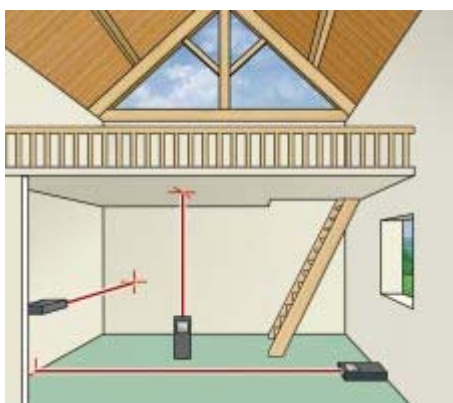
Mjerenje distance (izračunavanje površine/ volumena)
